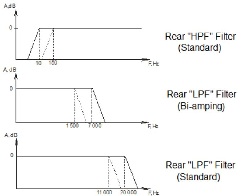
Схематическое изображение АЧХ программных фильтров задних каналов блока DSP с заводскими настройками
