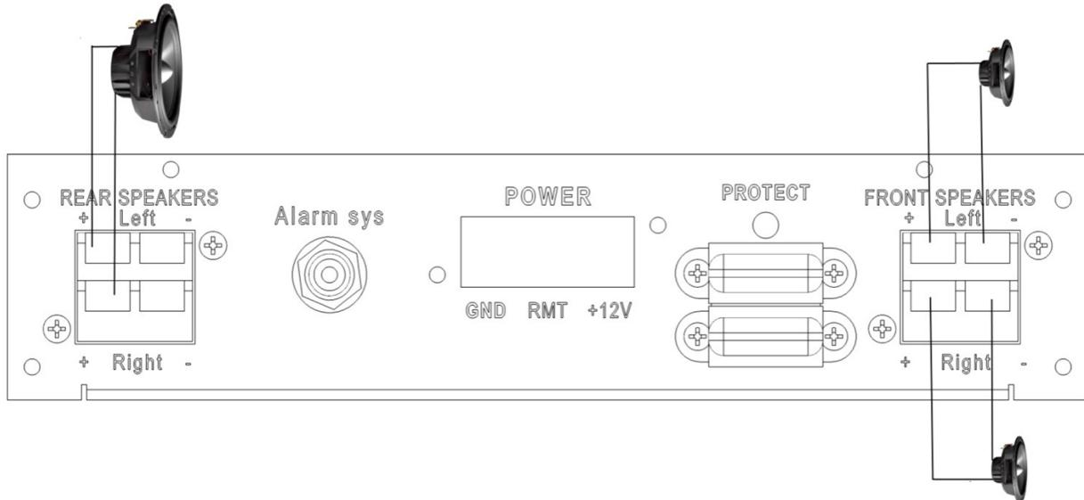
Схема подключения динамиков автомобильного усилителя X3 в «мостовом» режиме
