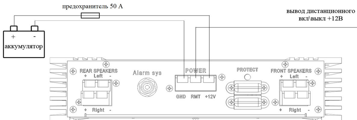
Схема подключения автомобильного усилителя X3
