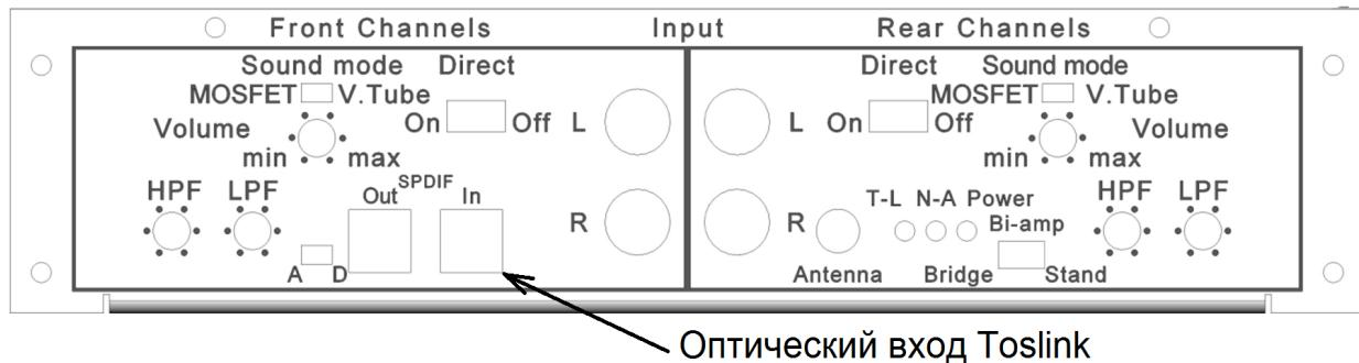
В данном режиме возможна подача сигнала на усилитель как по оптическому кабелю, так и по каналу BlueTooth. Если включен режим «Digital» и поданы сигналы «**Remote**» и «**Alarm sys**», то усилитель переключается в режим воспроизведения музыкального сигнала с одного из цифровых входов, который в данный момент подключен.
