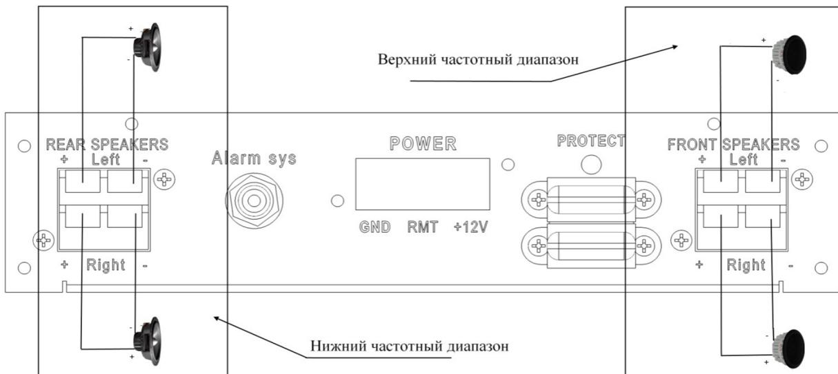
Схема подключения динамиков автомобильного усилителя X3 в режиме «**Bi-Amping**»
