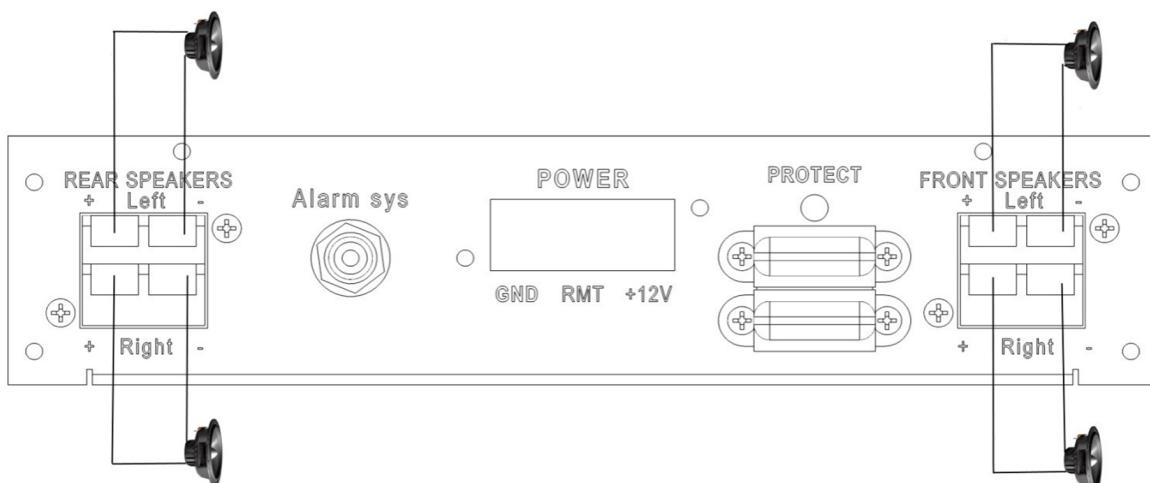
Схема подключения динамиков автомобильного усилителя X3 в «4-х канальном» режиме
