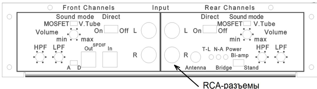
Сигнал в этом режиме можно подавать только через разъёмы RCA (см. рисунок выше). При этом доступны все варианты подключения, а также, цифровые фильтры.
