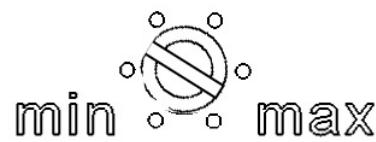
Затем, постепенно добавляя громкость на «головном» устройстве, добейтесь появления слышимых искажений. Слегка убавьте регулятор громкости «головного» устройства так, чтобы убрать слышимые искажения.
