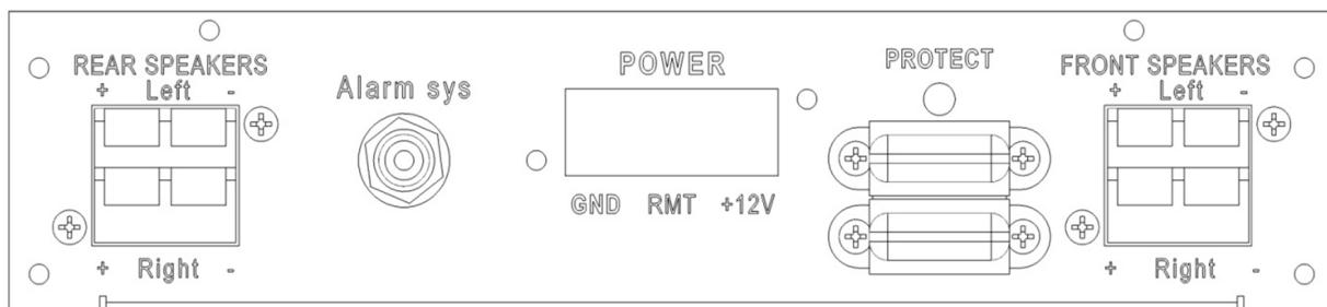
Задняя панель автомобильного усилителя X3
