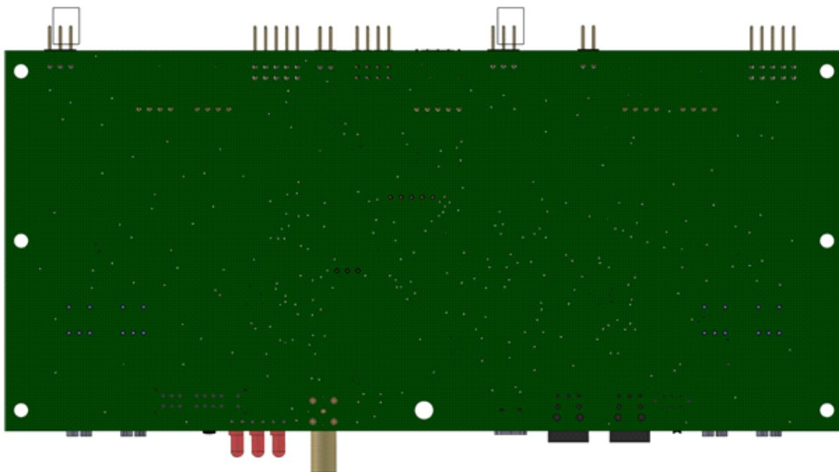
Фото платы блока DSP (ADAU\_CS) с исходным положением «джамперов»
